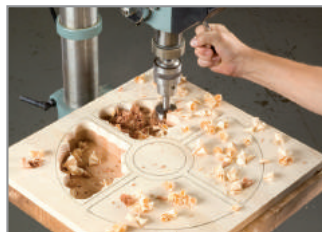
Benutzen Sie einen 50,8mm-Forstnerbohrer um so viel Abfall wie möglich zu entfernen.
