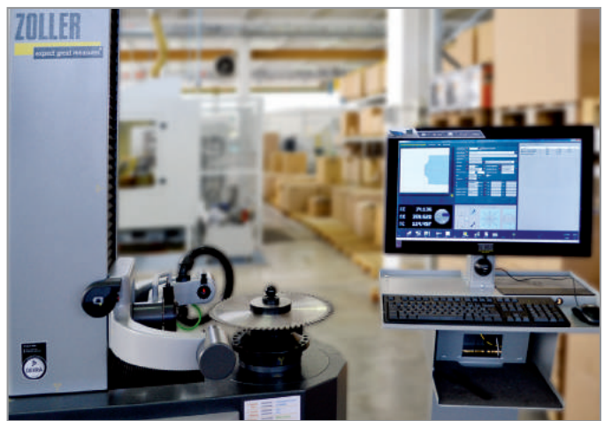
Das vollständig automatisierte CMT-Kontrollsystem.
