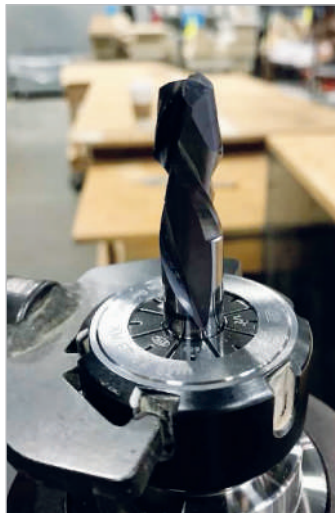
Fresa con rivestimento DLCS
