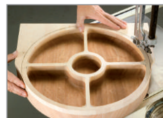
Rifinite la parte esterna del vassoio utilizzando una sega a nastro.
