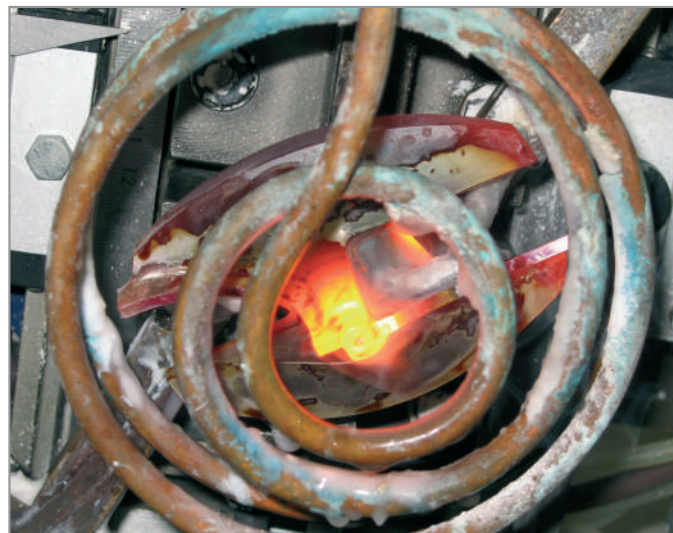
Saldatura a 680°C in pochi secondi.
