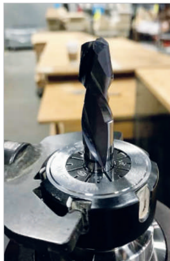
Fresa con rivestimento DLCS
