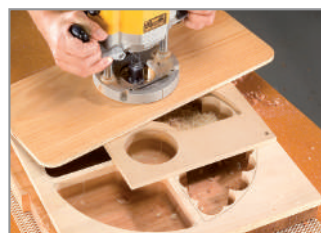
Rifinite l'interno utilizzando la fresa per vassoi inserita in una mandrino.
